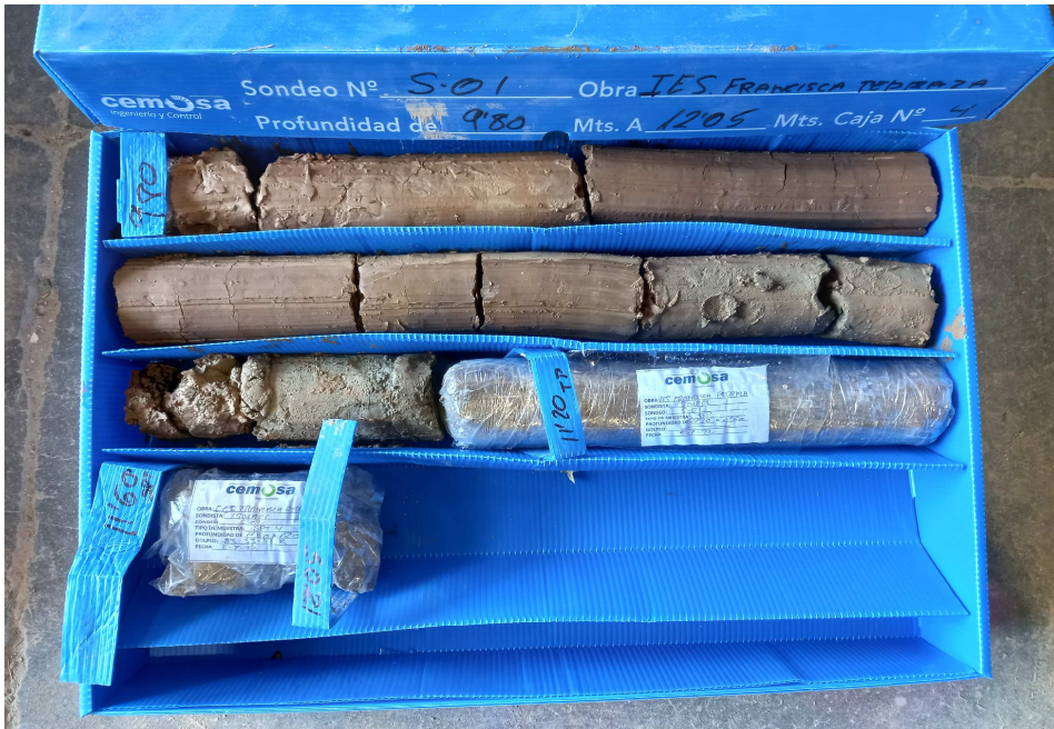
Foto de testigo de sondeo. Sondeo 1, Caja 4.
