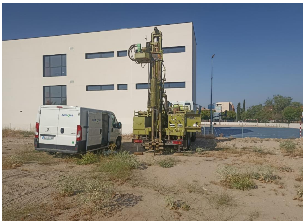
Figura Nº 10.- Trabajos para la realización de la penetración dinámica, tipo DPSH, referida como P-01.
