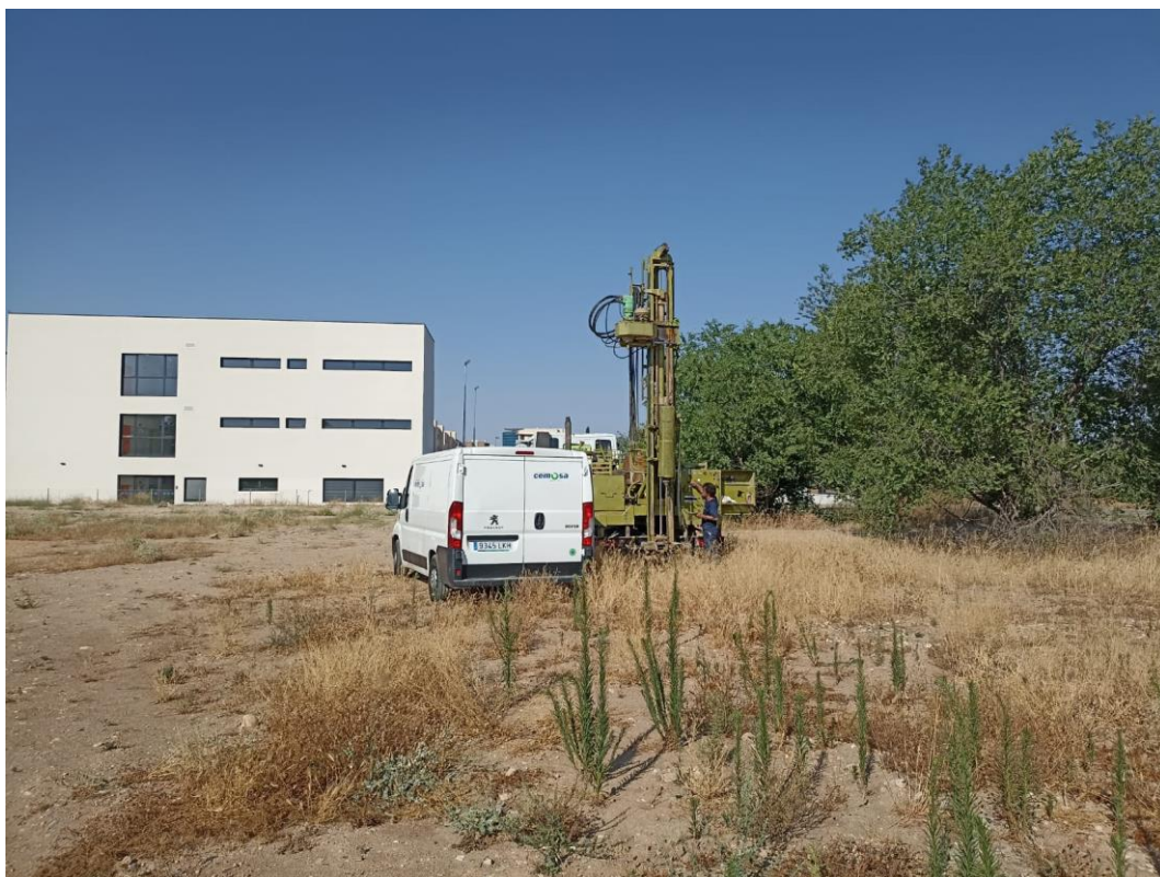
Figura Nº 11.- Trabajos para la realización de la penetración dinámica, tipo DPSH, referida como P-02.
